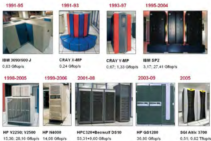
Figura 5. L'evolució del maquinari de supercomputació (1991-2005)
